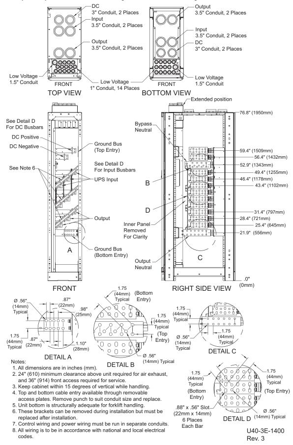
Figure 27 Input/output terminal detail, 400kVA, 480V Liebert NXL DC (2) 3" Conduit Output (2) 3.5" Conduit Ø.56 (14)Typ Bypass (2) 3.5" Conduit Input (2) 3" Conduit Input (2) 3" Conduit Bypass (2) 3.5" Conduit 1.75 (44)
