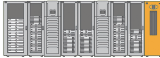
La Figura 1 muestra el uso más común del Liebert RDC (al final de una sección de racks).
